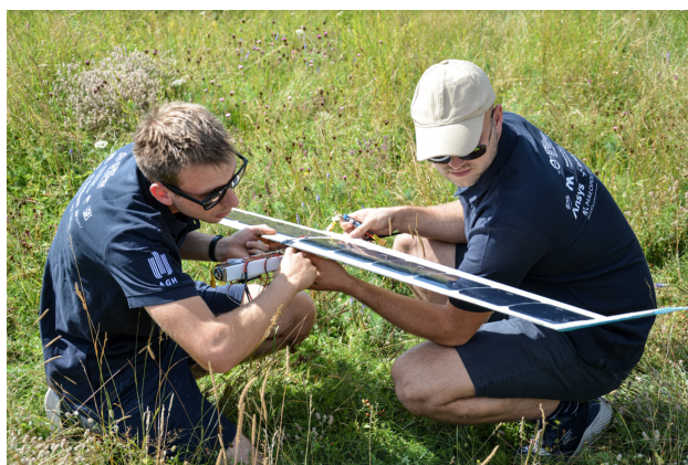
Oblot samolotu z ogniwami PV zalaminowanymi kompozytem szklanym.
